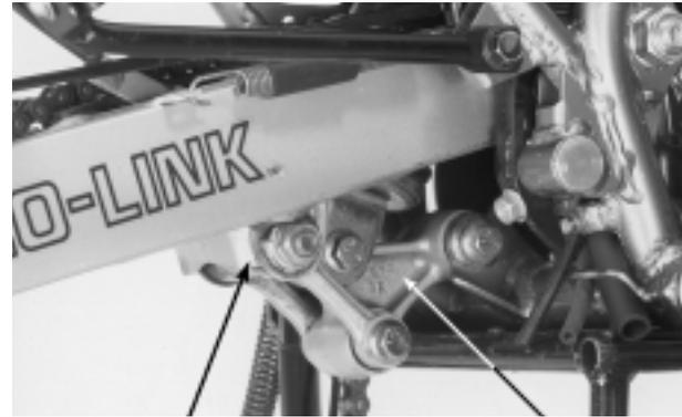
HASTE DE CONEXÃO BRAÇO DO AMORTECEDOR
