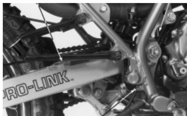
PARAFUSO DE FIXAÇÃO DO BRAÇO DO FREIO
