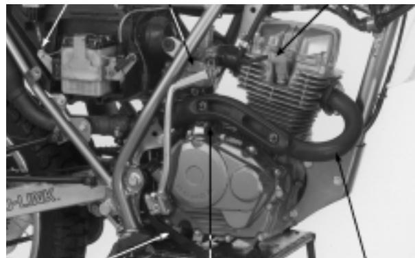
PEDAL DO FREIO CABO DA EMBREAGEM TUBO DE ESCAPAMENTO
