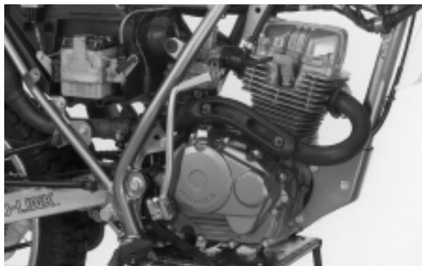
Remova os parafusos, porcas e espaçadores do suporte superior do motor.
