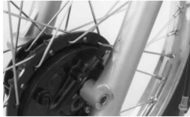
Instale o cabo do velocímetro.
