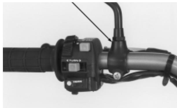
Instale a carcaça do conjunto de interruptores do lado direito do guidão introduzindo o pino da carcaça no orifício do guidão.
