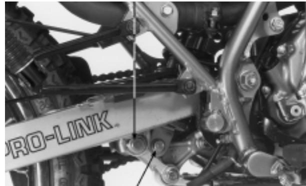
PARAFUSO DE FIXAÇÃO INFERIOR
