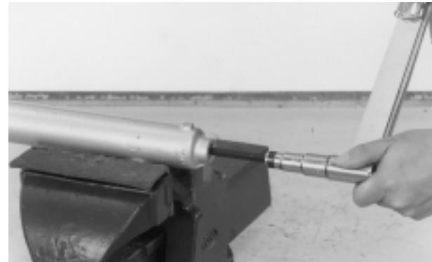
Instale a bucha do cilindro externo e o vedador de óleo, utilizando o instalador do retentor de óleo e a guia.
