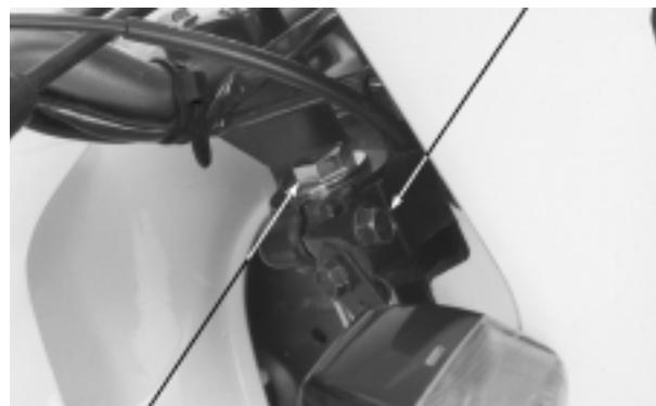
PARAFUSO SUPERIOR DO AMORTECEDOR
